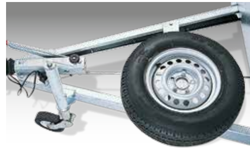
Ersatzrad auf Deichsel montiert (nur bei langer Zugdeichsel möglich)
