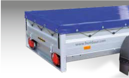
Flachplane (auch mit Bordwandaufsatz verwendbar)
