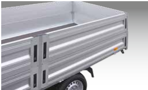
Bordwandaufsatz 350 mm, mit Mittelrunge
