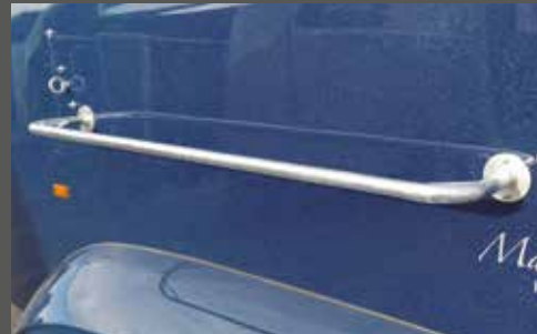
Sattelablagestange außen, feuerverzinkt
