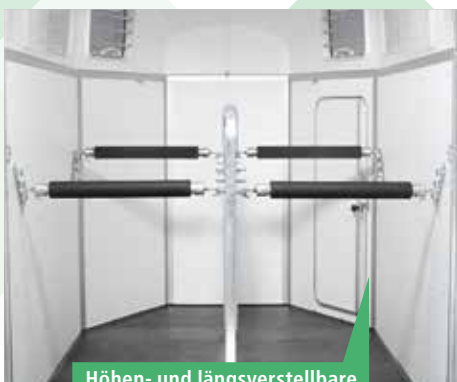
Höhen- und längsverstellbare Brust- und Heckstangen
