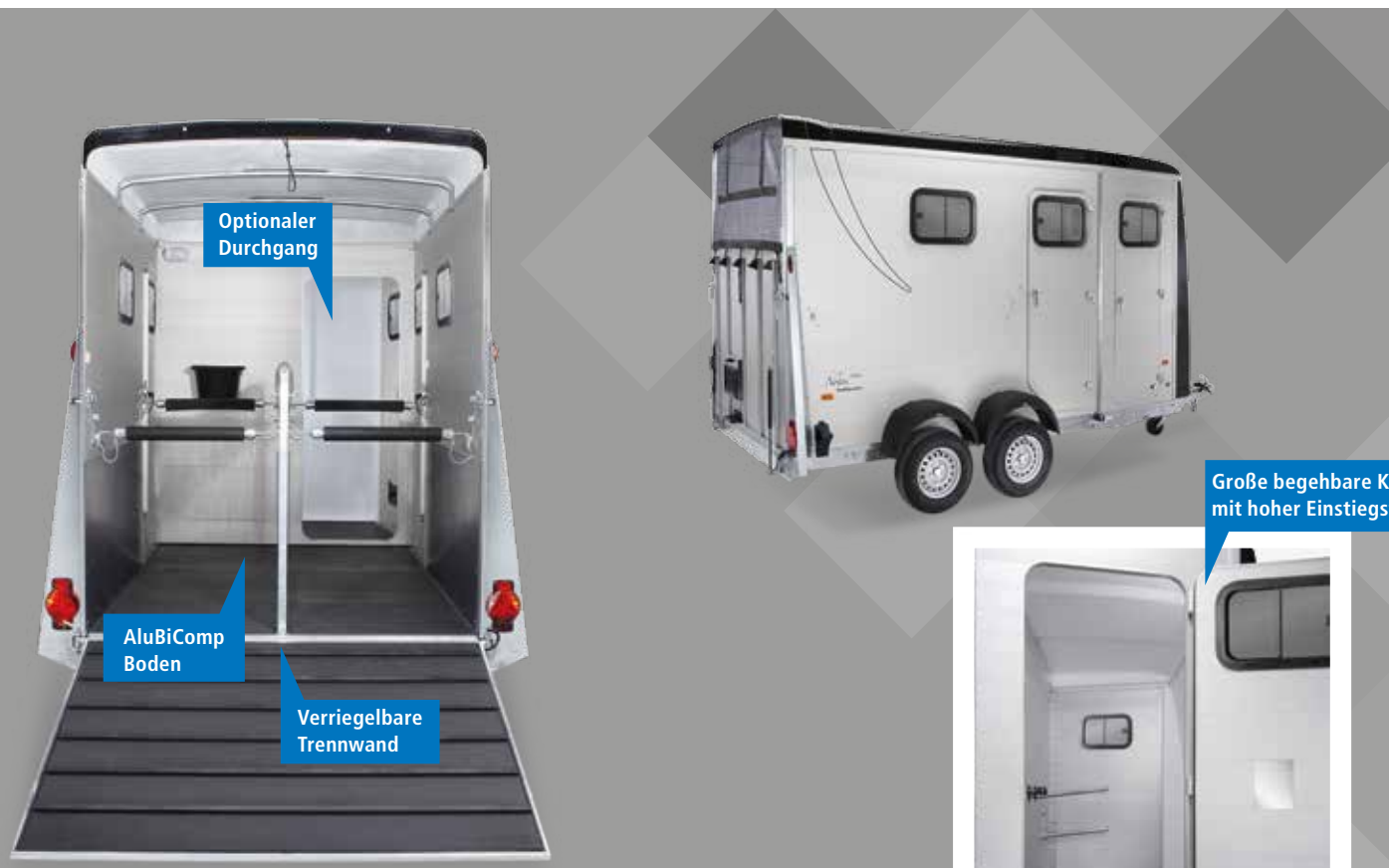
EquiSpace® Raumkonzept mit 3-fach verstellbaren Brust- und Heckstangen
