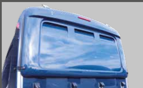
GFK-Windflap mit integrierter dritte Bremsleuchte (optional) für Balios®, Xanthos®, Zephir® und Maximus®
