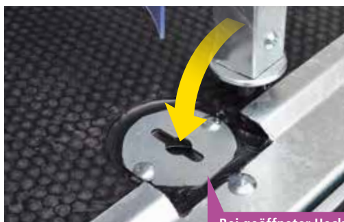
Bei geöffneter Heckklappe bleibt die Trennwand sicher verriegelt!
